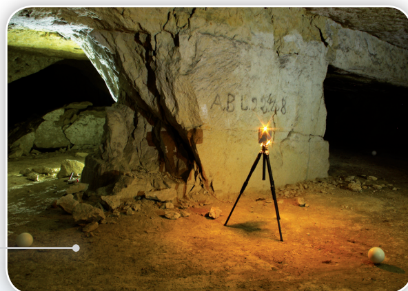
Image numérique 3D d'une mine souterraine et des enjeux de surface positionnés par UGPS (GPS souterrain)
