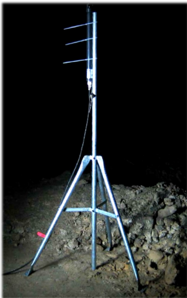
Surveillance acoustique pour la détection de chutes de blocs et craquements de roche
