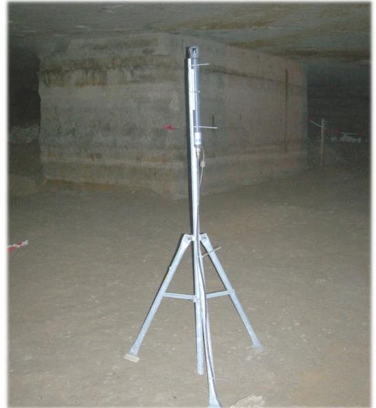
Offrant des caractéristiques métrologiques de haut niveau, la sonde 1DM est construite de manière robuste lui conférant une longue durée de vie et une grande facilité d'installation, dans des chambres, aux carrefours de galeries ou dans des niches protégées. Par définition, la sonde est facilement récupérable et déplaçable.
