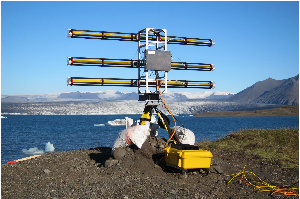
Figure A1 : Le radar interférométrique à ouverture réelle de la société Gamma Remote Sensing déployé sur site.
